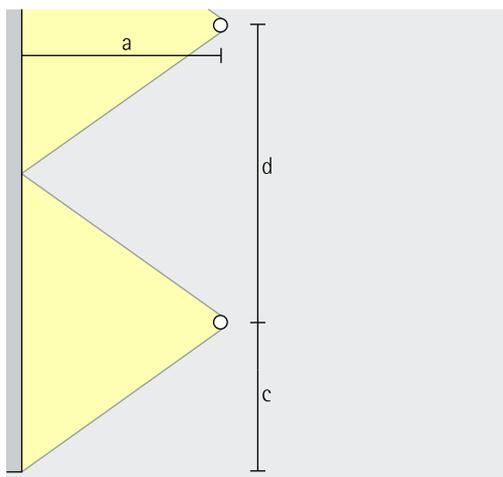
Pour une bonne homogénéité dans la longueur, l'entraxe (d) entre les appareils ronds à faisceau mural à lentille Tesis peut correspondre jusqu'à 1,3 fois la distance (a) au mur.
