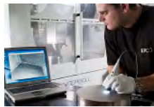
Optische Prüfung der mikrostrukturierten Oberfläche des Spherolit-Spritzgießwerkzeugs.
