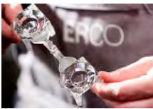
Visuelle Begutachtung während des Spritzgießprozesses bei der Kollimatorfertigung.
