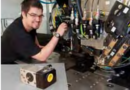
Wartung und Reparaturarbeiten an einem Stanz-Laser-Zentrum: Austausch des Laserkopfes als Kernstück der Anlage.
