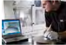
Optische Prüfung der mikrostrukturierten Oberfläche des Spherolit-Spritzgießwerkzeugs.
