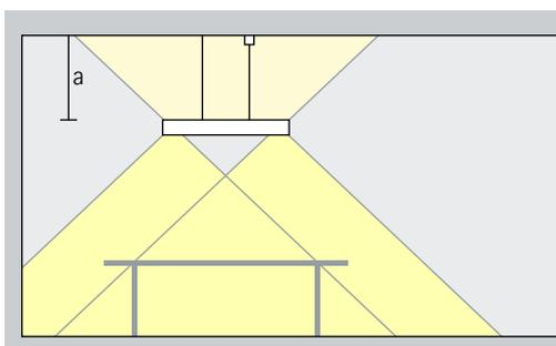
Una iluminación indirecta en techos claros aumenta el confort visual gracias a la reflexión difusa de la luz. Además, se incrementa la sensación de altura del espacio. A tal fin, la luminaria debería estar suspendida a una altura mínima de 0,5m.
