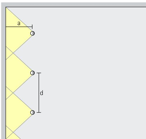
La distance (d) entre projecteurs à faisceau mural à double foyer peut représenter jusqu'à 1,3 fois la distance jusqu'au mur (a) pour obtenir un éclairage à faisceau mural avec une homogénéité longitudinale élevée.
