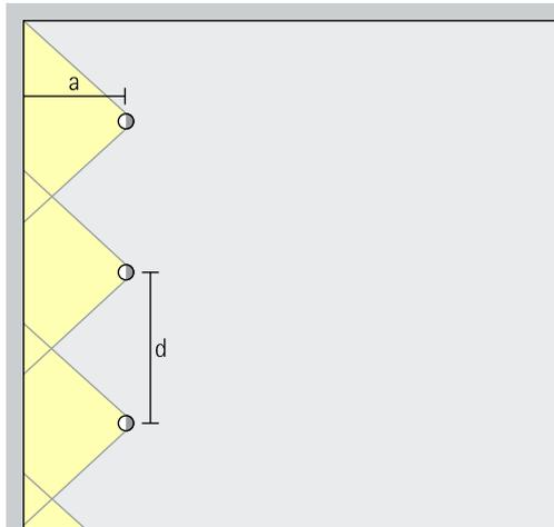
Pour une bonne uniformité longitudinale, l'entraxe (d) de deux appareils à faisceau mural à lentilles Uniscan peut s'élever jusqu'à 1,2 fois la distance par rapport au mur (a).
