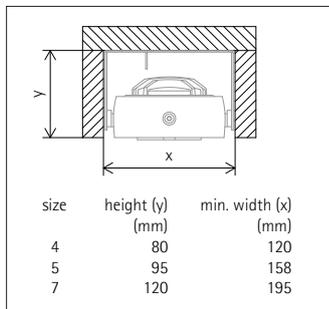
**Dimensionierung des Deckenkanals**
